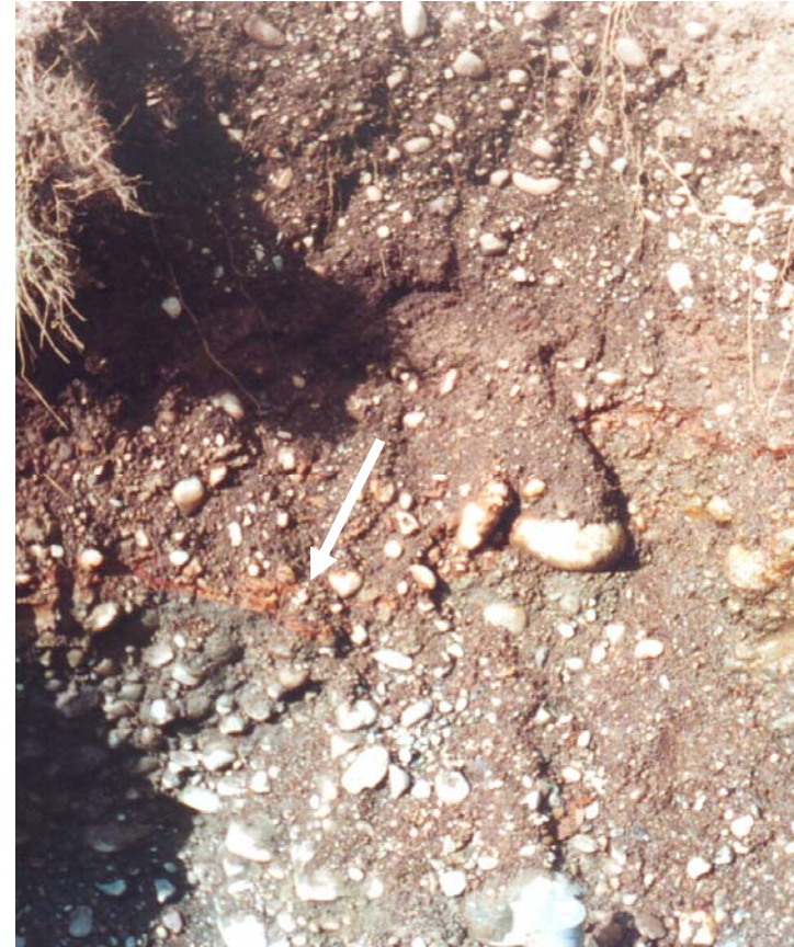
b) Depositación de óxidos de metales, como indicio de una infiltración de aguas
